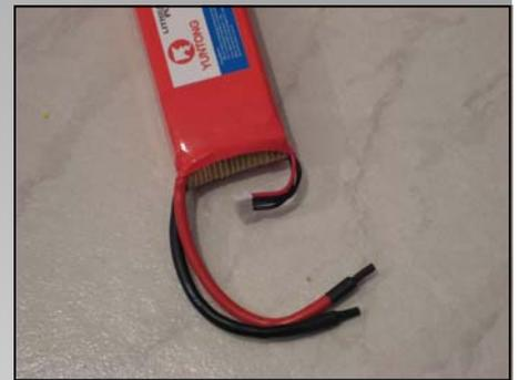
Temperaturanstieg, maximal bis handwarm. Die Zellen zeigen keinerlei Tendenz dicker zu werden, oder sich in irgendeiner anderen Form zu verändern. Die Abmessungen sind immer noch die gleichen. Die Erfahrung zeigt, dass es auch Zellen gibt die nach einigen Ladezyklen fast doppelt so dick sind wie zu Beginn. Die „Yuntong“ allerdings nicht.
