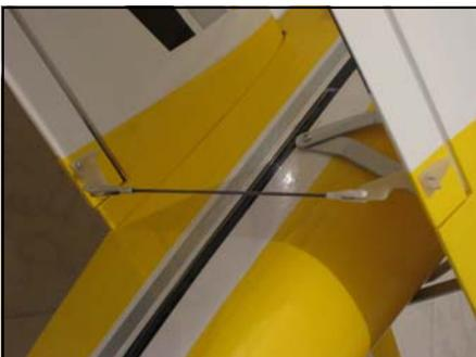
*Die Verbindung der Querruder erfolgt mittels Stahldraht und Gabelköpfen.*
