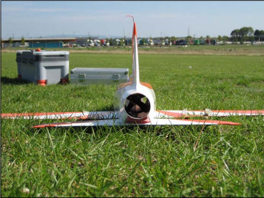
*Hier ist schön das dünne Profil des „Super Sniper“ zu erahnen. Der Impeller wartet darauf seinen Dienst zu tun. Das glänzende im Inneren ist die Folie des Schubrohres.*
