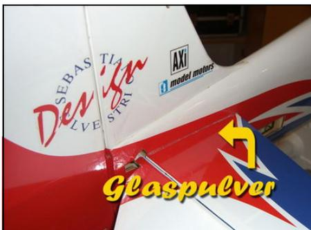
Der Spalt der durch die Montage entsteht wird mit Glaspulver geschlossen
