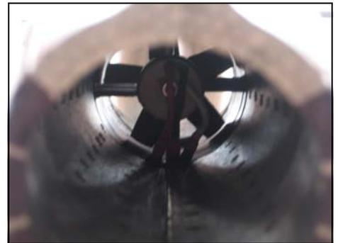
*Hier ist der Impeller inkl. Motor und Anschlusskabeln zu sehen.*
