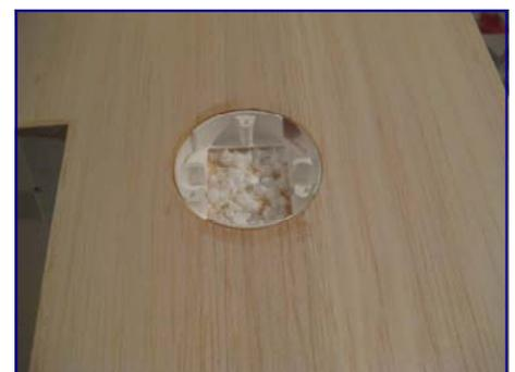
*Die Ausnehmungen für die Servo-Lock müssen etwas vertieft werden*
