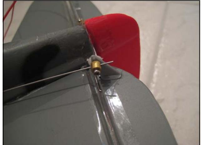
*Hier sind die Anlenkungen zu sehen. Aus Komfortgründen wurde das mit Gestängeanschlüssen realisiert.*
