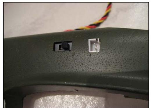
*Die Schalterplatine mit der Ladebuchse von der Außenseite des Rumpfes.*
