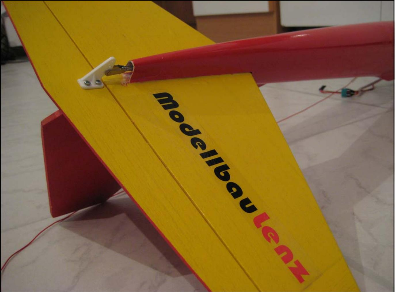
Das Höhenruder wird mittels CFK-Rohr, mit eingeklebten M3 Gewindestangen und Gabelköpfen angelenkt. Ist man hier sorgfältig, ist die Anlenkung 100% spielfrei.
