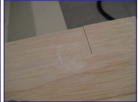
*Die Ruder werden mit Fliesscharnieren befestigt -> Klebung an der Oberseite.*
