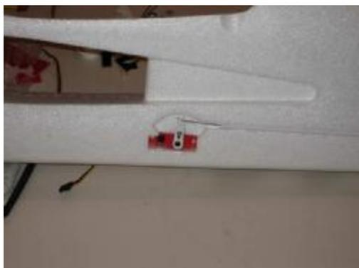
Wie bei allen Modellen von Multiplex ist der Bau auch durch die hervorragende Bauanleitung ein Kinderspiel. Alle Teile passen "saugend schmatzend" zusammen und werden mit ein paar Tropfen Superkleber und Activatorspray fixiert. Die Servos werden in die vorgesehenen Einbauplätze gesteckt und halten eigentlich schon bombenfest. Dennoch werden Sie an den Seiten mit Superkleber fixiert.
