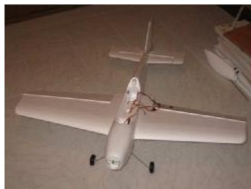
Wenn alles ein- und zusammengeklebt ist werden die Anlenkungen eingehängt, der Empfänger, und Motor-Regler eingebaut. Die Justage des Motors (Seitenzug, Sturz) ist mit dieser, hoffentlich patentierten, Motorhalterung ein Gedicht. Denn 4 Stell-schrauben ermöglichen perfekte Kontrolle.
