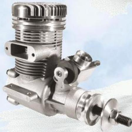
Ein robuster, leistungstarker Motor, ideal für den Einsatz in Kunstflug- und Scalemodellen. Hohe Stabilität durch Monoblockgehäuse aus Alu-Druckguss. Für konstanten und kraftvollen Motorlauf sorgt die Zylinderlaufgarnitur mit traditioneller Stahlbuchse, Rechteck-Kolbenring und Leichtmetallkolben.
