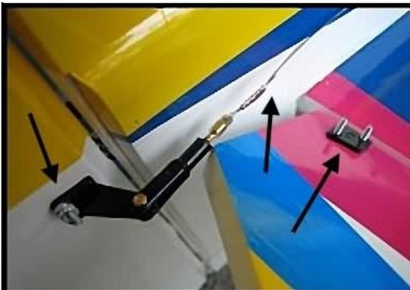
ganz kurz abgeschnitten werden. Anschließend werden sie mit einem Tropfen Kleber versiegelt. Der zweite auffällige Mangel ist die Seitenruderanlenkung. Man sieht deutlich am Bild, dass das Seil nicht gespannt ist. Nun ist aber auf dem Seitenruder beim Flug eine Kraft wirksam, die dieses bewegen will. Durch die mangelhafte Spannung hat das Seitenruder rechts und links minimalen (ca. 2-5 mm an der Ruderhinterkante) Spiel. Nicht gravierend, aber bei schnellen
