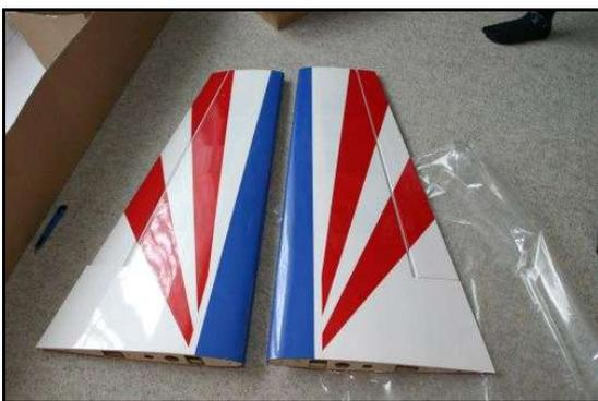
Die **Tragflächen** sind in herkömmlicher Rippenbauweise gebaut, von der Nasenleiste nach hinten bis zur Mitte mit Balsa beplankt. Die Ausschnitte für die Befestigung der Servos sind perfekt gearbeitet und haben an den Verschraubungsstellen noch zusätzlich Aufgedoppeltes Material, um einen sicheren Halt zu gewährleisten. Mehrfache Sicherheit der Flächenbefestigung am Rumpf durch 2 Federn, die die Flächen zusammenhalten, je 2 Zentrierstifte und je eine Verschraubung (M4
