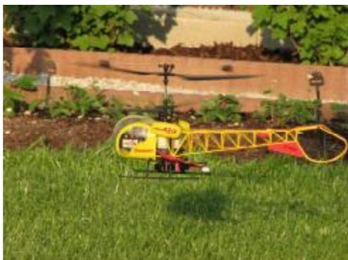
Setzt man den Hubschrauber in Bewegung versucht die Stabilisierungsstange dies mit Hilfe des oberen Rotors wieder auszugleichen, dies wird daran erkennbar das eine gestartete Bewegung nach einigen Metern wieder etwas langsamer wird.
